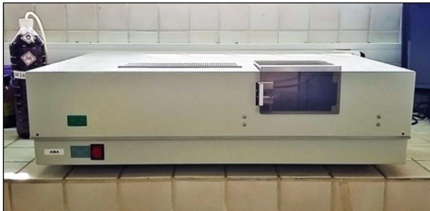
Figure 4 : Analyseur AMA 254 utilisé pour mesurer la concentration de mercure dans la chair des poissons
